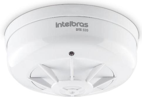
El DTE 520 monitorea la variación de temperatura o si se traspasa el límite fijo del producto. A través del protocolo de comunicación este sensor de temperatura le envía al panel la ubicación exacta del fuego. Es recomendado para ambientes con polvo o humo, los cuales no se recomienda la aplicación del detector de humo.
